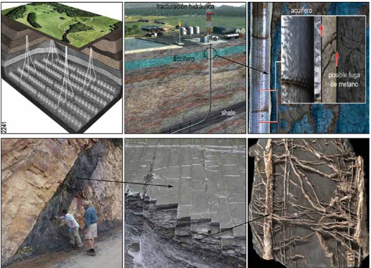
2241. Fracturación hidráulica de las rocas. Consiste en 2 etapas: la perforación y direccionamiento horizontal del pozo (arriba-izquierda) y la ruptura de la roca mediante presión hidráulica (agua, arena y compuestos químicos). Un peligro es la filtración de gases desde la perforación hacia los acuíferos subterráneos (derecha). La roca madre está empapada de gas o petróleo pero reclusos en "bolsas" microscópicas (abajo), de forma que la fractura de la roca libera los hidrocarburos retenidos y se pueden bombear a la superficie.
